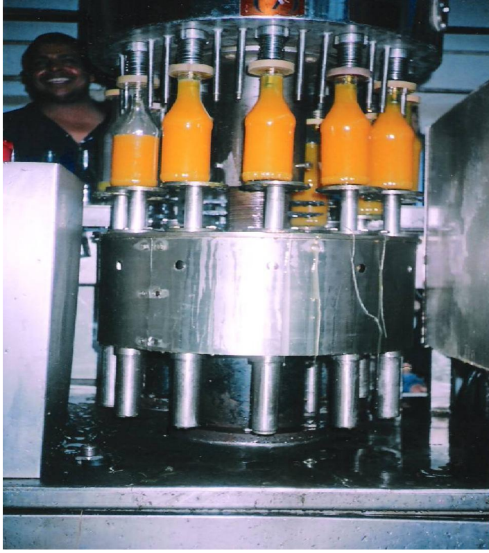
شكل رقم (9-1) آلة تعبئة العصير فى عبوات زجاجية
